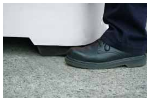
El conjunto de la carretilla se extiende hasta el suelo minimizando el riesgo de que los pies puedan quedar atrapados.
